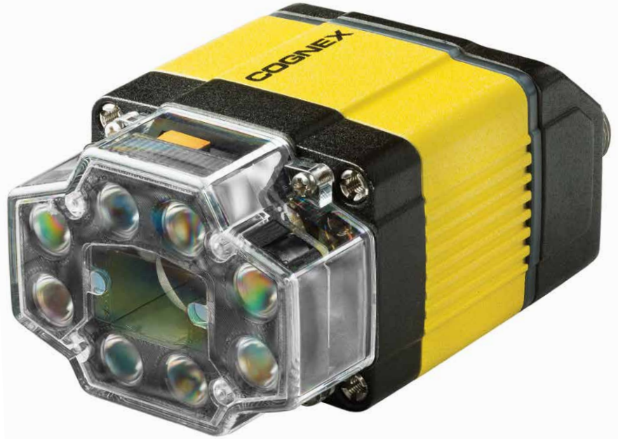
DataMan 360 시리즈 모델은 360도 비주얼 판독 지시기를 제공하는 조명 링과 시스템 레벨의 백업, 간편한 장치 복구 및 대체를 위한 Micro SD 카드를 제공한다.
